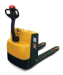
Литиевая тележка для работы с поддонами отличается маневренностью и малым радиусом поворота при загруженном весе. Она подходит для работы в сверхузких проходах. Литиевый блок спроектирован очень компактно, а конструкция обеспечивает надежность. Компоненты расположены так, чтобы технические специалисты могли легко и безопасно обслуживать их.
