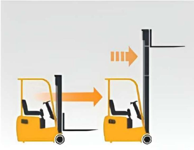
Автоматическая регулировка скорости при высоком подъёме груза.
