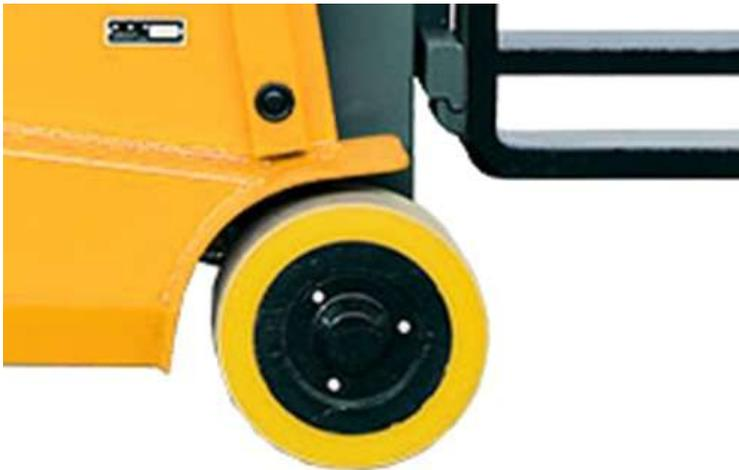
Малый диаметр колёс, снижает передний свес вилочного погрузчика Aurora ТКА15.
