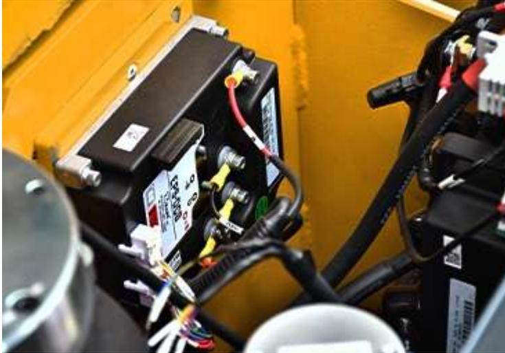
Модифицированная версия контроллера управления ZAPi, улучшает работу погрузчика и повышает уровень безопасности эксплуатации.
