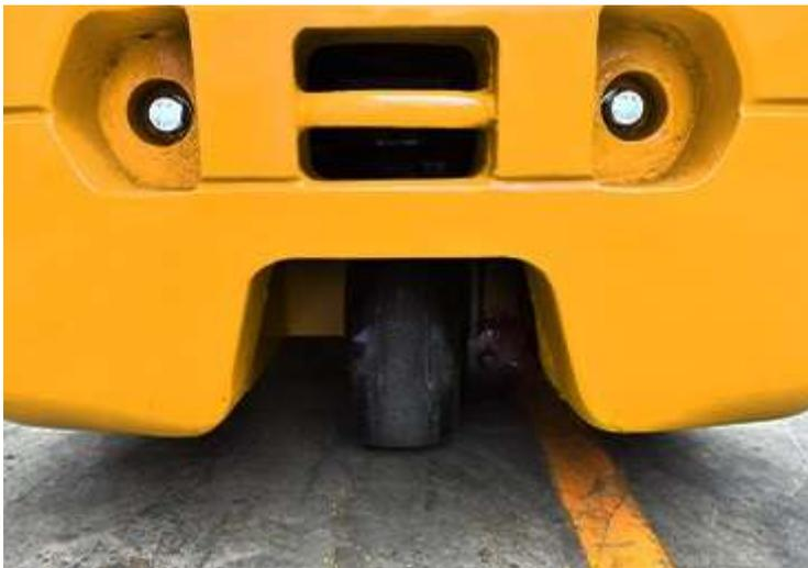
Колёса из полиуретана с высокопрочными подшипниками.
