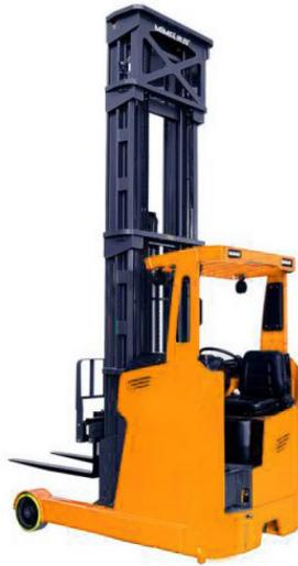
Aurora MFZ20 — электрический ричтрак с управлением сидя, подходящий для работ в достаточно узких проходах. На складах со средней плотностью хранения и высокой скорости оборота.
