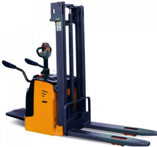
Штабелер Aurora MB15 грузоподъемностью 1,5 т использует необслуживаемую высокомоощную систему привода переменного тока, которая обеспечивает надежную мощность привода. Аккумулятор большой емкости 210 Ач обеспечивает отличную выносливость.
