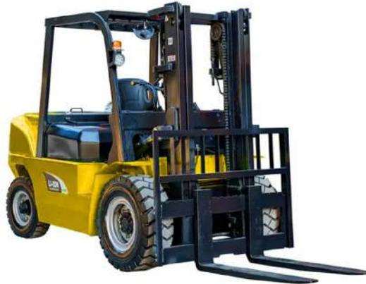
Крупнотоннажный вилочный погрузчик Aurora FB50 с литиевым аккумулятором серии N грузоподъемностью от 5000 кг имеет конструкцию с прочным шасси, надежной рамой и мачтой.
