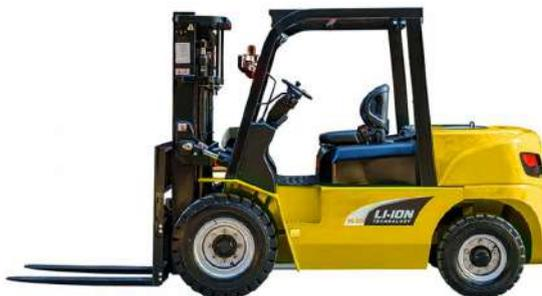
Крупнотоннажный вилочный погрузчик Aurora FB45 с литиевым аккумулятором серии N грузоподъемностью от 4500 кг имеет конструкцию с прочным шасси, надежной рамой и мачтой.
