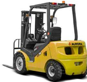
Вилочный погрузчик Aurora FB25 серии N с литиевым аккумулятором грузоподъемностью 2500 кг имеет надежную конструкцию с прочным шасси, рамой и мачтой.
