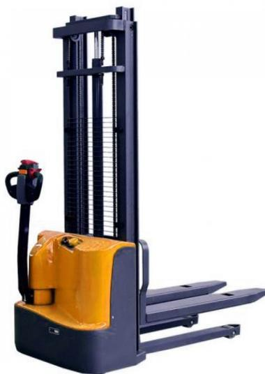
Электрический штабелер Aurora MBD15 грузоподъемностью 1,5 тонны с максимальной высотой подъема 2500 мм - идеальное решение для погрузки, разгрузки и обработки грузов на складах, в супермаркетах, мастерских.
