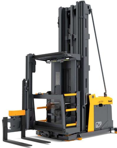
Новейший узкопроходный штабелер с высотой подъема от 4 500 до 15 500 мм обеспечит максимальную производительность при выполнении складских операций в узких проходах, начиная от захвата поддонов, транспортировки, штабелирования.
