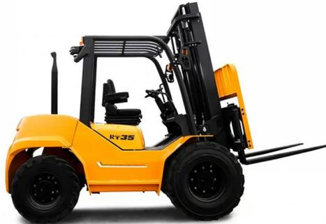
Внедорожный вилочный погрузчик серии Aurora R2D25 предназначен для использования в сложных условиях, где требуется повышенная проходимость. Погрузчик имеет привод на 4 колеса (4WD). Его конструкция придает машине прочную конструкцию и гибкость в различных условиях пересеченной местности.
