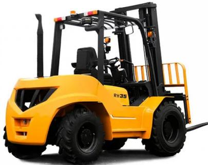
Внедорожный вилочный погрузчик серии Aurora R2D25 предназначен для использования в сложных условиях, где требуется повышенная проходимость. Погрузчик имеет привод на 2 колеса (2WD). Его конструкция придает машине прочную конструкцию и гибкость в различных условиях пересеченной местности.
