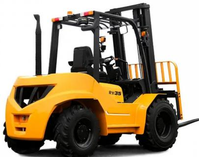
Внедорожный вилочный погрузчик серии Aurora R4D35 предназначен для использования в сложных условиях, где требуется повышенная проходимость. Погрузчик имеет привод на 4 колеса (4WD). Его конструкция придает машине прочную конструкцию и гибкость в различных условиях пересеченной местности.
